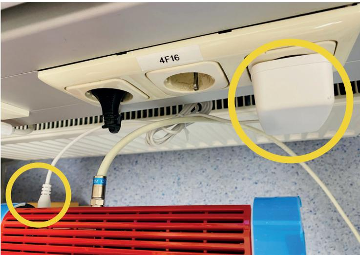
Stecken Sie nun das weiße Netzteil an das Stromnetz an und schließen Sie das andere Ende beim Modem an.
